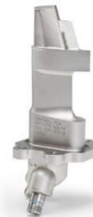
Корпус датчика температуры на входе в компрессор двигателя GE. Сертифицирован FAA в 2015 г.
