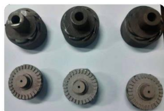
Напечатанные заготовки стремлящего аппарата и рабочего колеса
